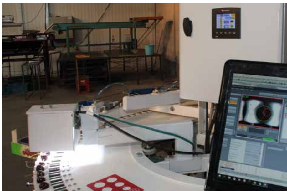
Overzichtsfoto gehele opstelling met Unitronics PLC + HMI rechtsboven
