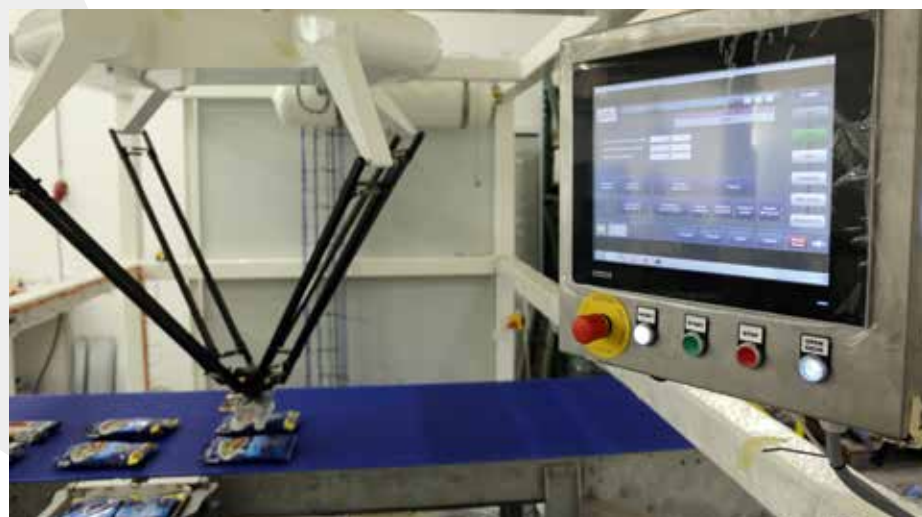
Advantech 'true flat' Panel PC (IP66) met op de achtergrond de inpaklijn met robot
